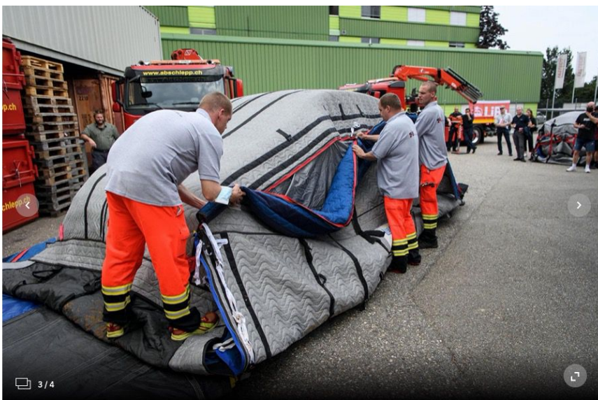
Die Bergungsdecke aus nicht brennbarem Spezialgewebe lässt zwar Rauch hinaus, das Feuer im Innern erstickt aber an Sauerstoffmangel. Foto: Dominik Plüss
