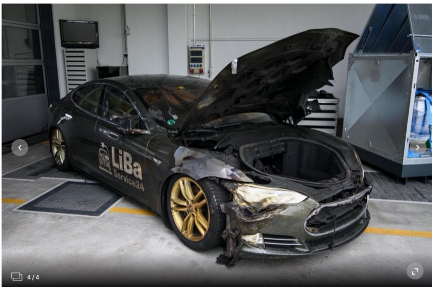
An einem Tesla hat LiBa die Bergungsdecke getestet. Er brannte zwar, aber es kam nicht zu einem Vollbrand, bei dem Löschwasser eingesetzt werden musste oder die Gefahr bestanden hätte, dass sich andere Gegenstände in der Nähe entzündeten. Foto: Dominik Plüss
