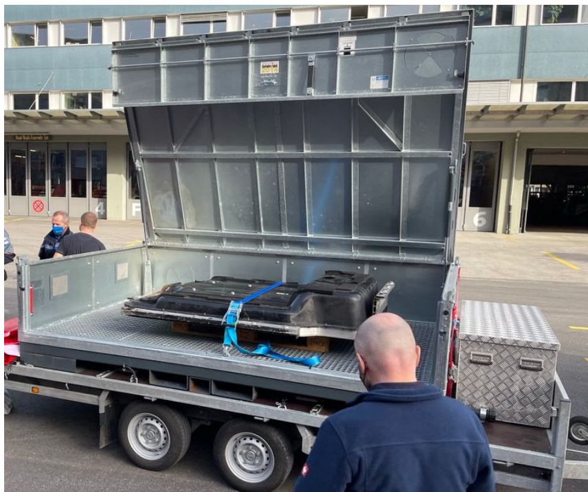
LiBaRemorque pour la quarantaine et le transport selon l'ADR (SDR) de batteries au lithium-ion, par exemple la batterie de traction d'une voiture électrique.
