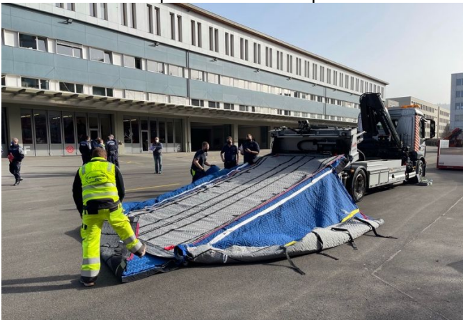
Emballage de la voiture électrique directement sur le camion. Ainsi, l'espace consommé est minimal, la circulation n'est pratiquement pas entravée.
