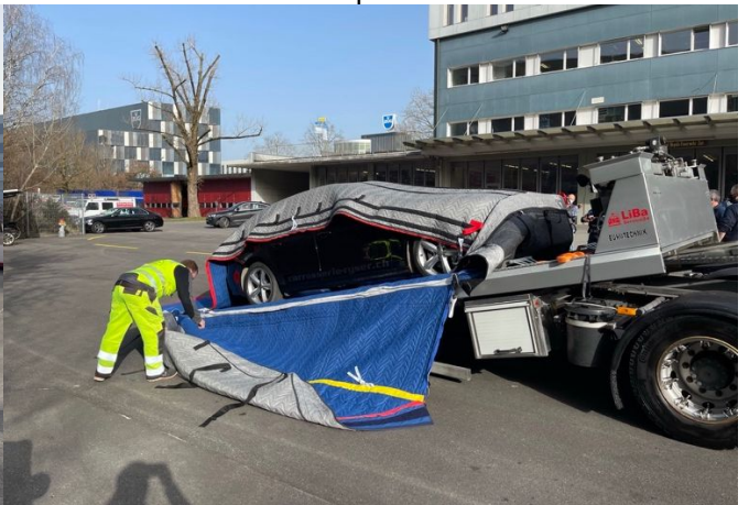
Emballage de la voiture électrique directement sur le camion. Ainsi, l'espace consommé est minimal, la circulation n'est pratiquement pas entravée.
