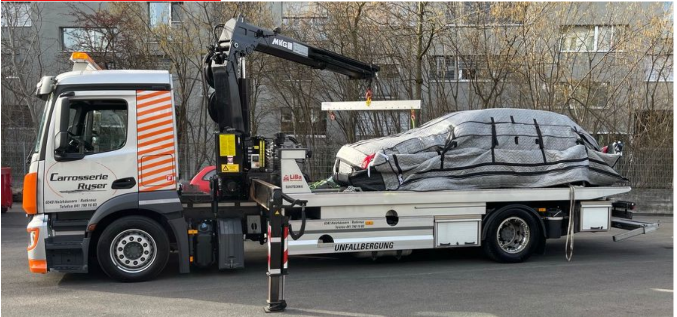
Voiture électrique emballée dans le LiBaRescue, prête à être déchargée avec la grue
